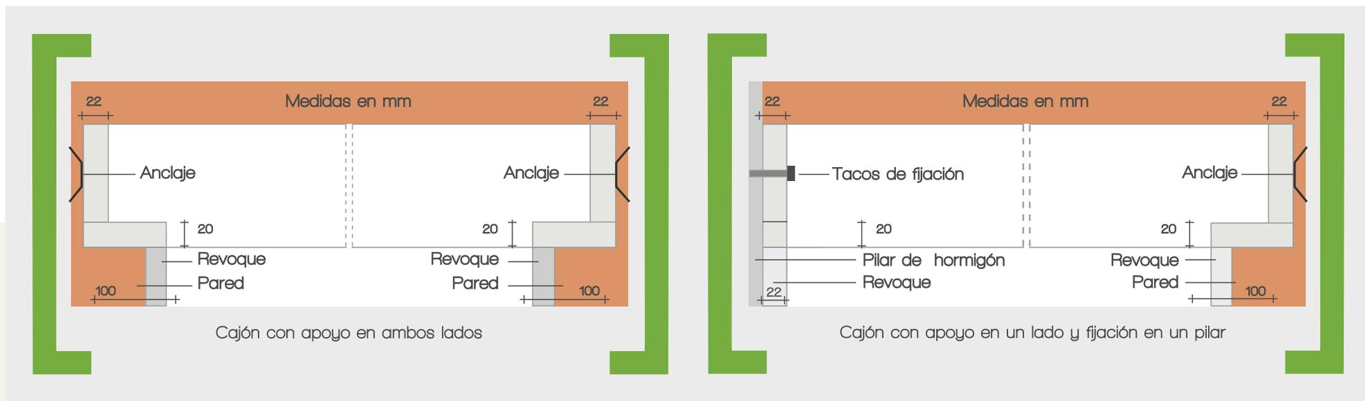
En la fabricación se añade en ambos lados un apoyo de 100 mm para accionamiento a motor y de 135 mm para accionamiento a cinta. Si un pilar o muro de carga impide tener apoyo, la medida de la placa de apoyo en ese lado será 22 mm, que es el espesor del testero y el grosor del premarco. En el lado donde va situado el accionamiento, es necesario, según este los siguientes apoyos mínimos:
