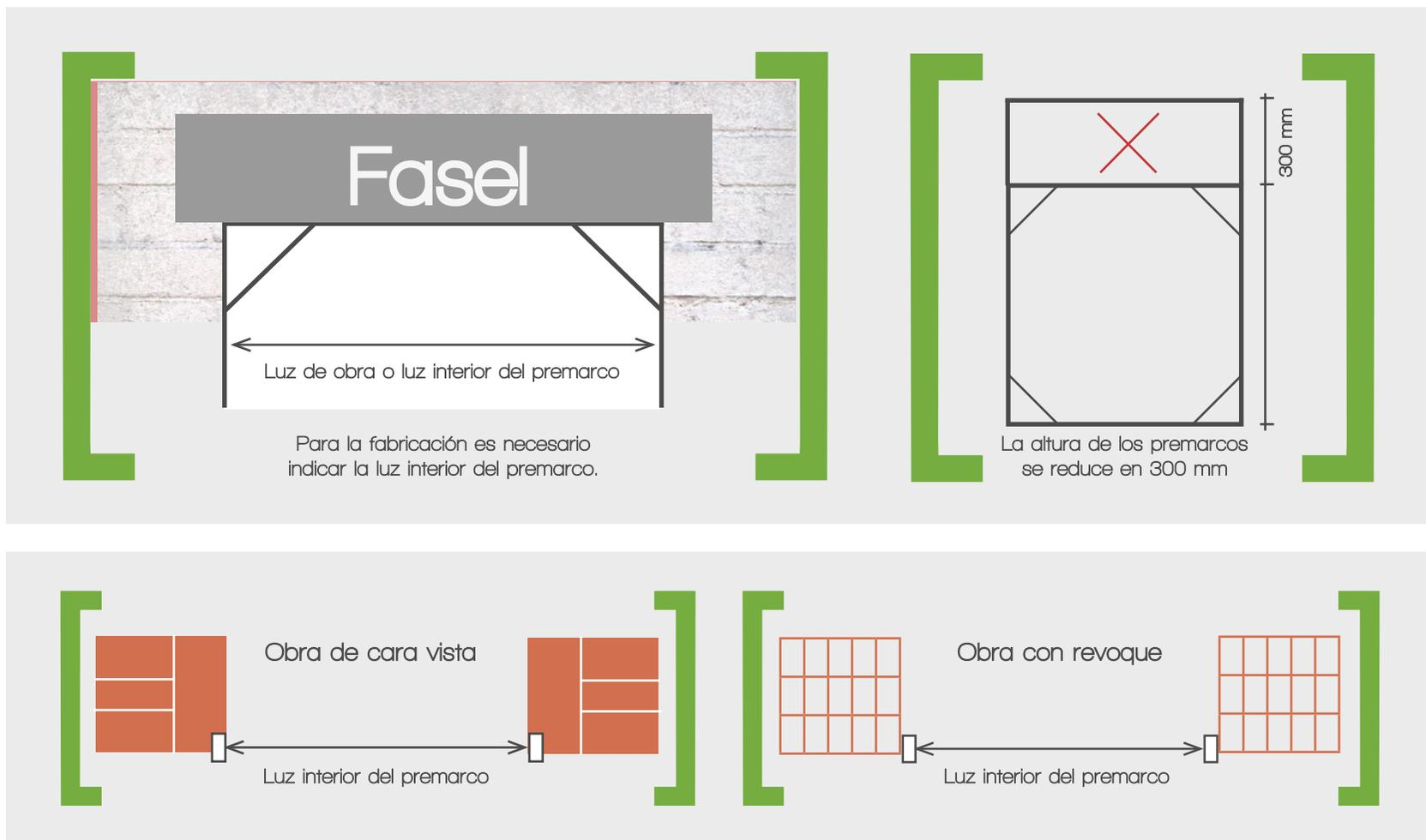
Para una correcta instalación se debe indicar el ancho luz de obra acabada, el espesor total de la pared incluyendo el enyesado con el revoque o el ladrillo de cara vista.
